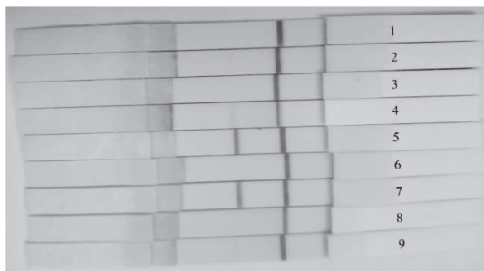
图 4 市售 9 个配方羊奶粉样品胶体金免疫层析法检测结果
